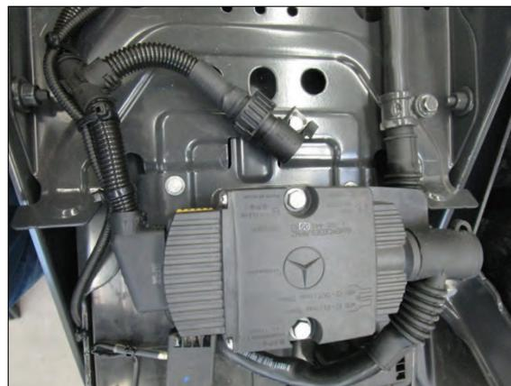
**Bemerkung:** Nachträglicher Einbau eines elektrischen Batterietrennschalters. Elektronische Batterie-Trennschaltersteuerung. Trennt nach Stilllegung des Fahrzeuges nach einer Zeitspanne von ca. 5 Min. die Fahrzeugbatterie von der elektr. Anlage. Sicherheitstechnische Einrichtungen wie z.B. Standlicht, Warnblinkanlage usw. deaktivieren die Trennschaltung. Anlage wird über einen Kippschalter in der Instrumententafel aktiviert
