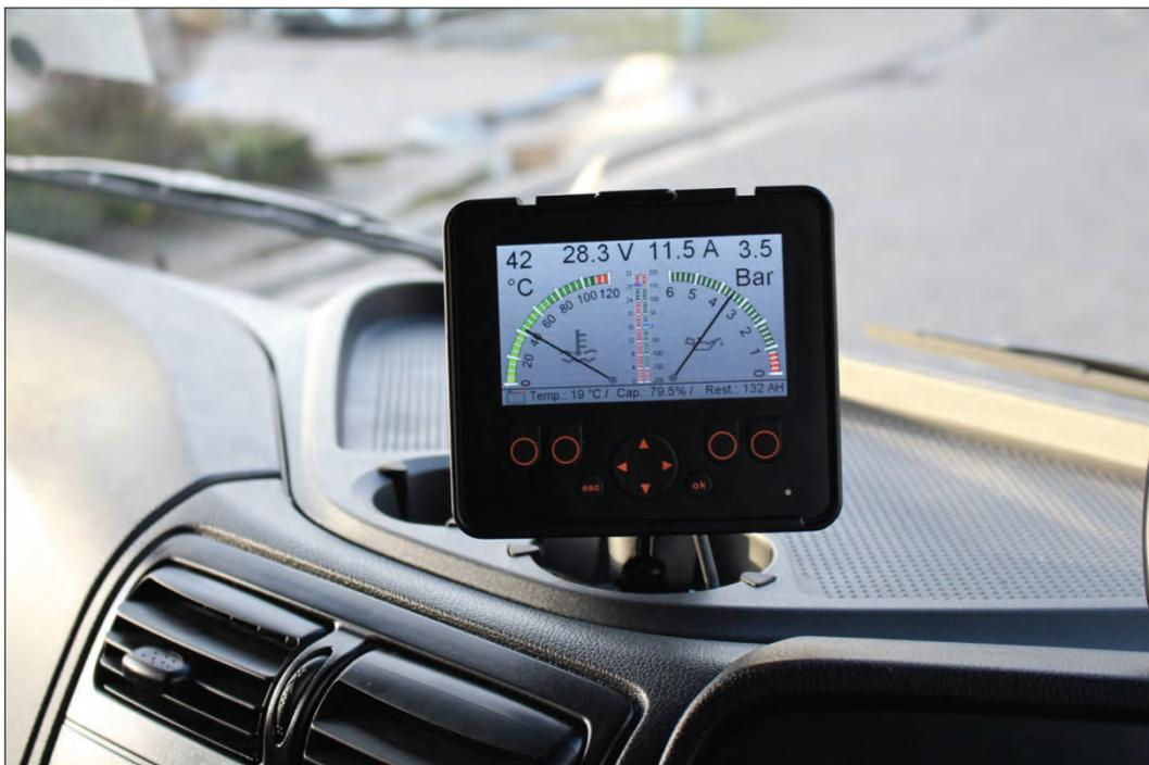
**Bemerkung:** Nachträglicher Einbau von Dialogsystem/Anzeigedisplay
