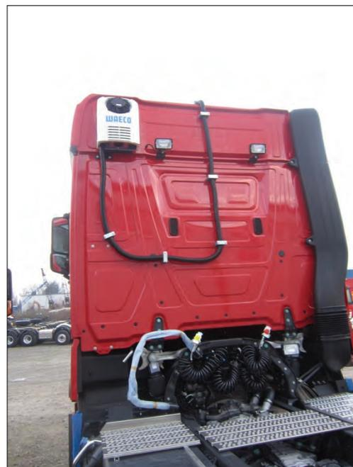
**Bemerkung:** Nachträglicher Einbau einer 24 V Standklimaanlage.
