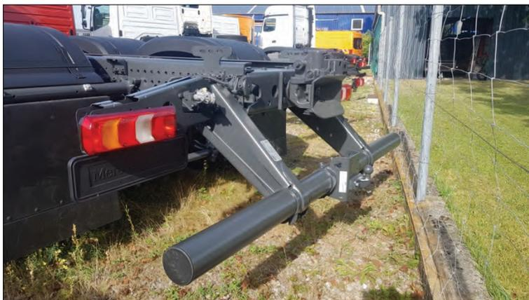
**Bemerkung:** Nachträglicher Einbau einer Kugelkopfanhängerkupplung inkl. Montagebock zur Befestigung am Fahrgestellrahmen. TÜV-Abnahme.
