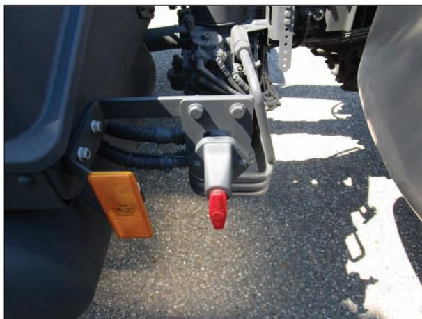
**Bemerkung:** Nachträglicher Einbau eines mechanischen Batterietrennschalters.
