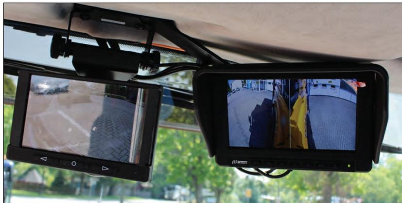
**Bemerkung:** Einbau eines Abbiegekamerasystems mit Reinigungsfunktion
