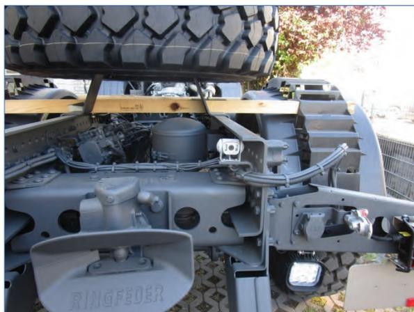
**Bemerkung:** Nachträglicher Einbau diverser Rückfahrvideosysteme
