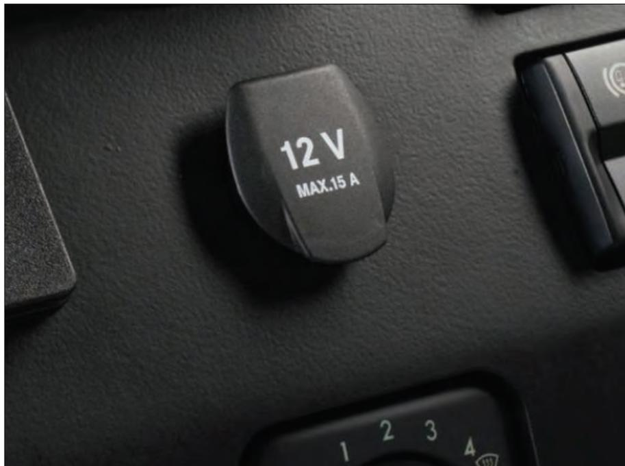
**Bemerkung:** Nachträglicher Einbau einer 12 V Steckdose in der Instrumententafel.
