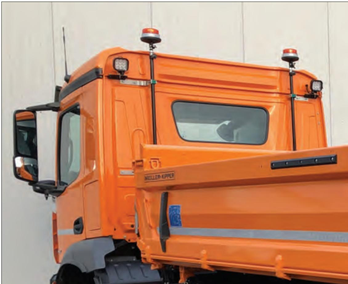
**Bemerkung:** 2 Rundumkennleuchten in LED-Ausführung, montiert auf höhenverstellbaren Stativen an der Fahrerhausrückwand.
