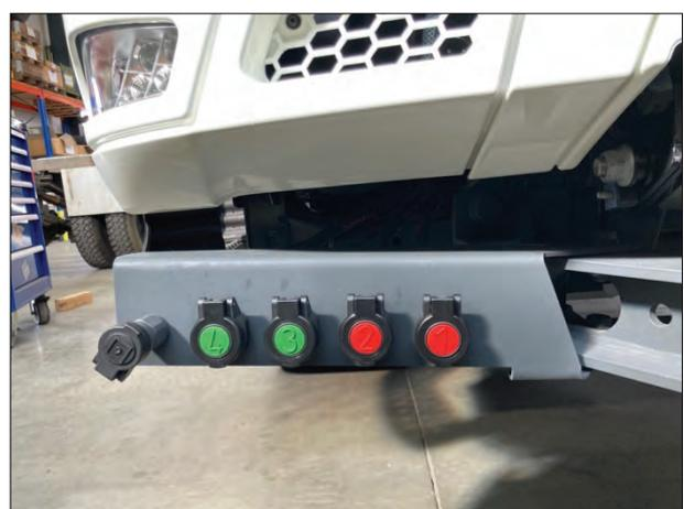
**Bemerkung:** Nachträglicher Einbau einer LS Hydraulikanlage, zum Betreiben von mehreren Hydraulischen Verbrauchern. Z.B Kommunalhydraulik und Abrollkipper.
