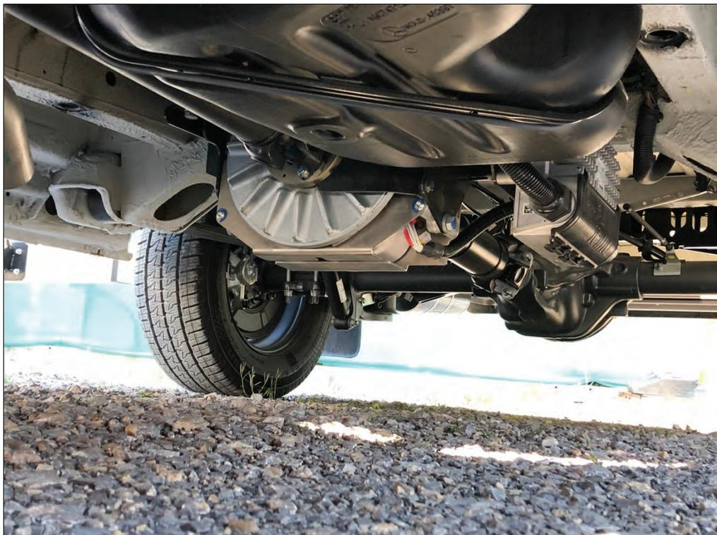
**Bemerkung:** Einbau einer Telma Wirbelstrombremse
