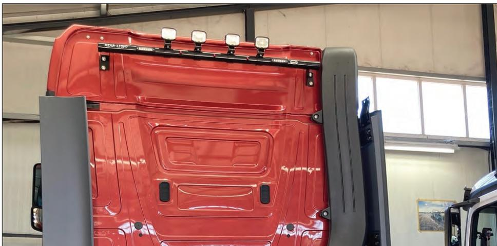
**Bemerkung:** Nachträglicher Einbau einer „Light-Bar“ hinter dem Fahrerhaus
