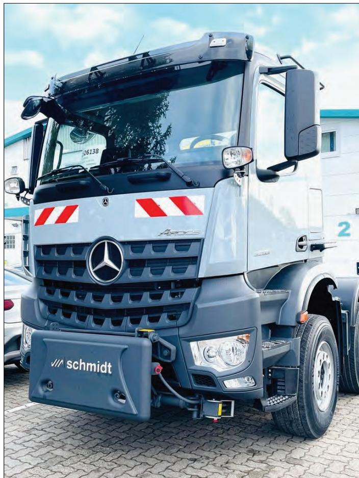
**Bemerkung:** Fahrzeugseitige Geräteanbauplatte nach DIN EN 15432-1, Typ F1/C Form A bzw. Größe 5 mit patentierter Überlastsicherung zur Vorbeugung von Schäden am Fahrzeugrahmen / 2 frontseitig montierte Zusatzscheinwerfer mit Abblendlicht, Fernlicht und Blinkleuchten für den Schneepflugbetrieb („Winterdienst-Beleuchtung“) / Steckdose (24V; 3-polig/7-polig) für die Pflugbegrenzungsleuchten.
