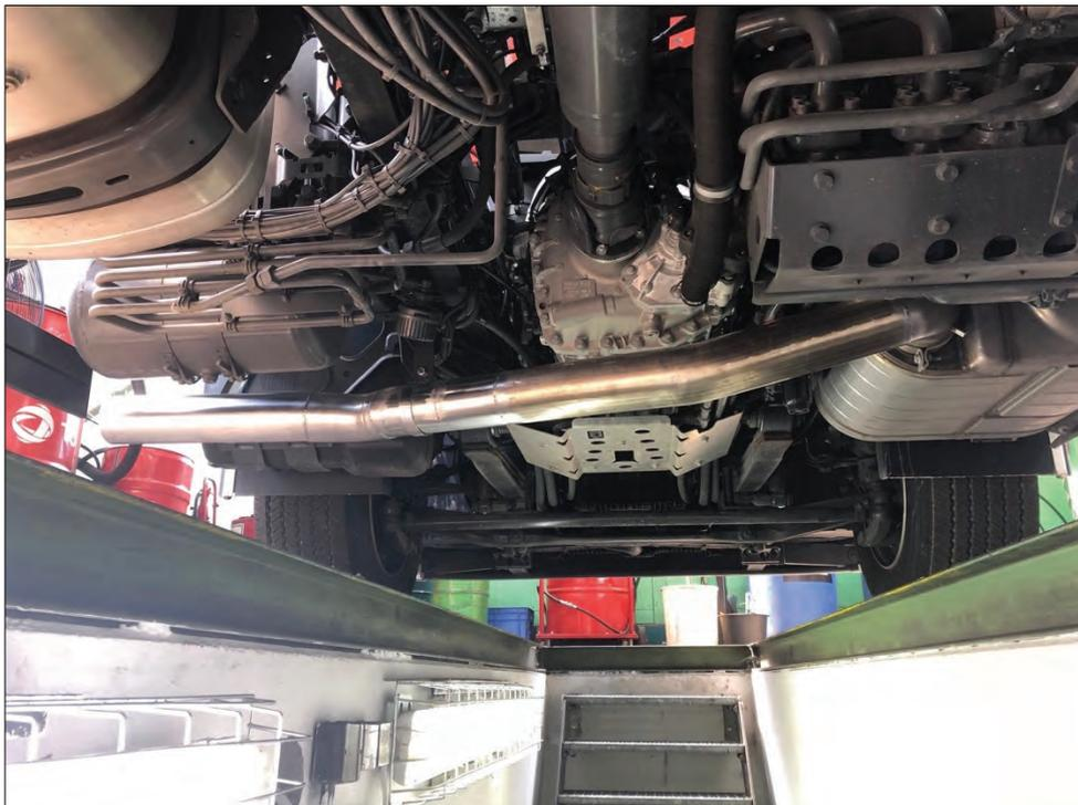
**Bemerkung:** Verlegung des Abgasendrohres zur linken Rahmenseite verlegen
