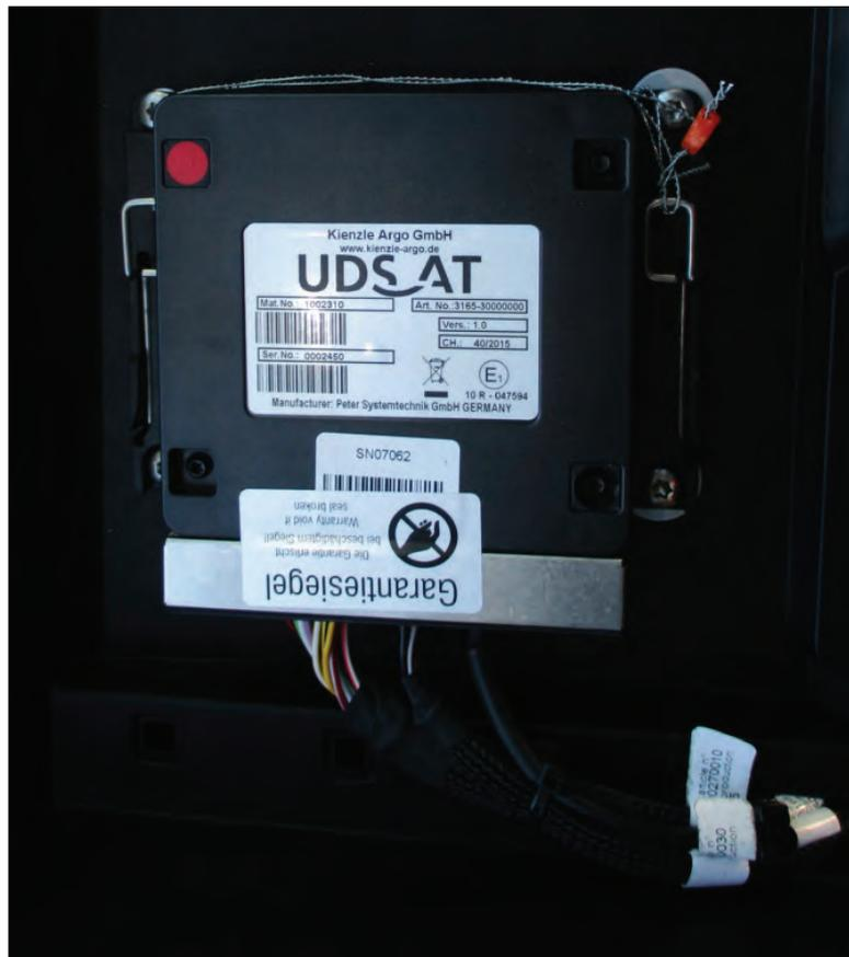
**Bemerkung:** Nachträglicher Einbau eines Unfalldatenspeicher Typ UDS AT
