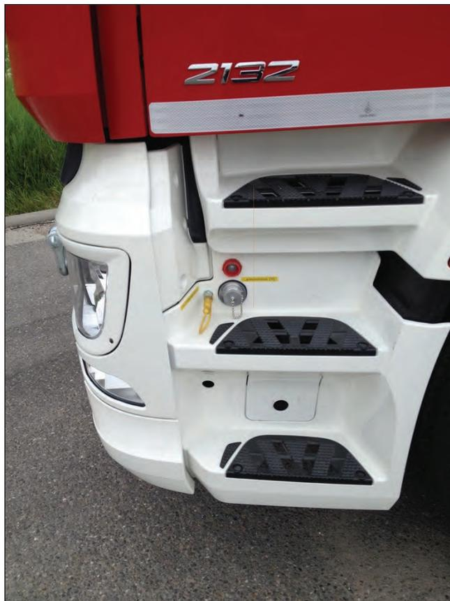
**Bemerkung:** Nachträglicher Einbau einer 24 V Ladesteckdose im Bereich Fahrerhauseinstieg links.
