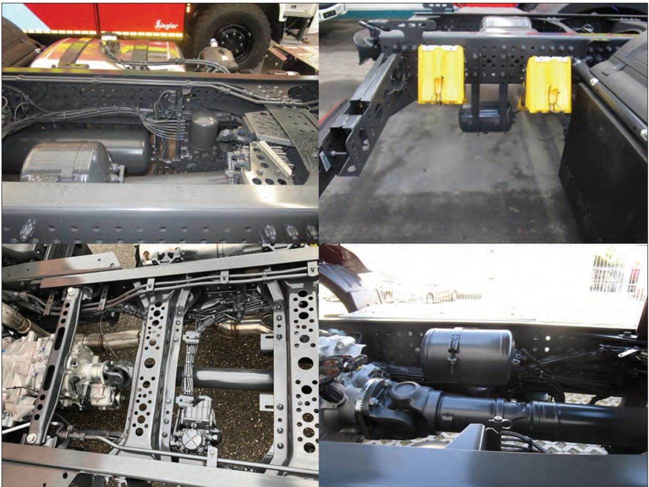
**Bemerkung:** Versetzen der Luftbehälter, und Ventilen in den Rahmen nach Vorgabe ABH oder Absprache zur Darstellung Freiraum ABH
