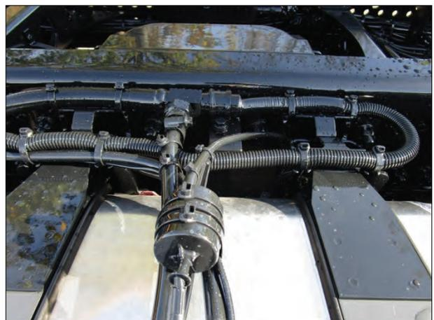
**Bemerkung:** Einbau von Heizelementen für Kraftstoffleitung, Tank, Batterien und Motor um den Betrieb in Kältegebieten zu erleichtern. Betrieben über 24 V Bord Spannung oder über Einspeisung von 230 V
