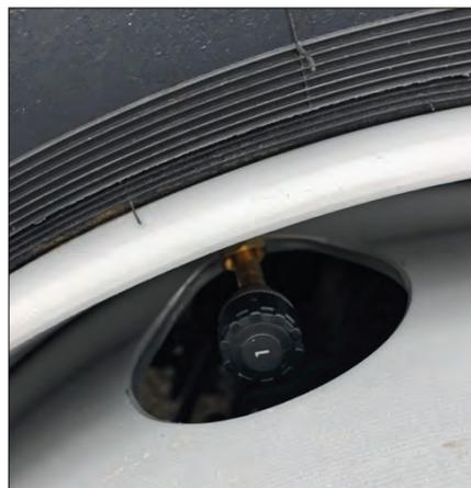
**Bemerkung:** Reifendruckkontrollanlage mit Display im Fahrerhaus und Sensor an Jedem Rad
