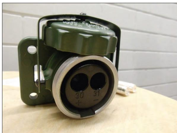
**Bemerkung:** Nachträglicher Einbau einer Fremdstartsteckdose im Bereich Batteriekasten
