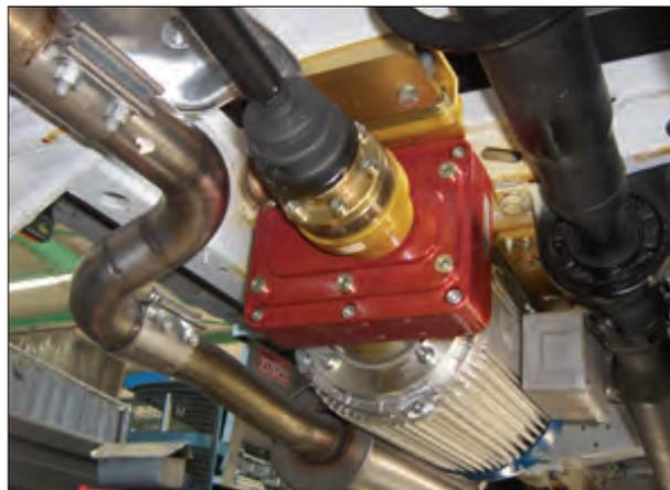
**Bemerkung:** Nachträglicher Einbau 230 V Dynawatt-Anlage
