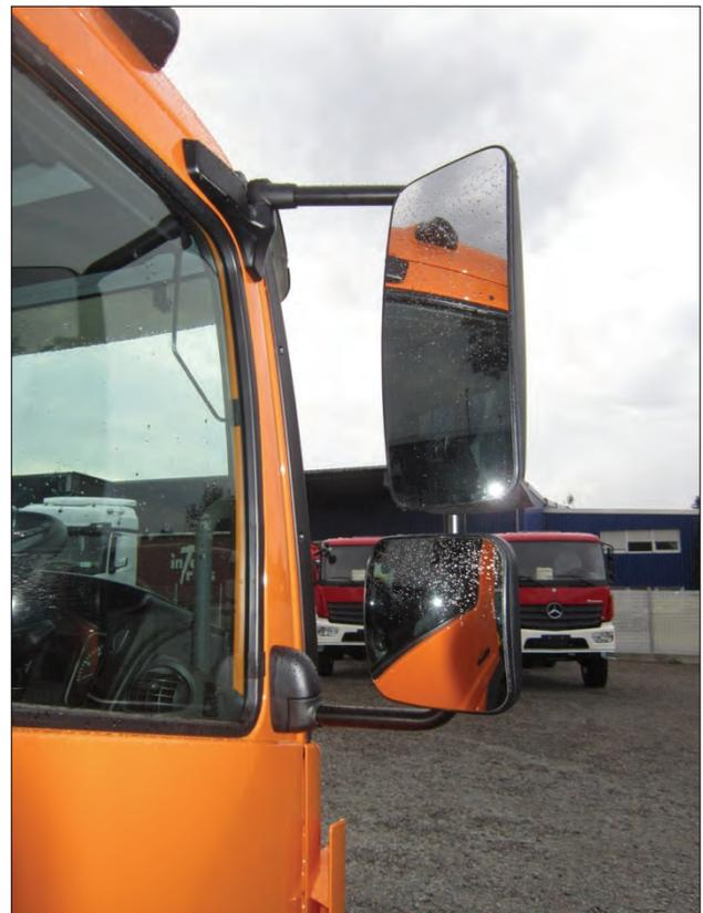
**Bemerkung:** Nachträglicher Einbau Weitwinkelspiegel rechts und links elektrisch verstellbar und heizbar
