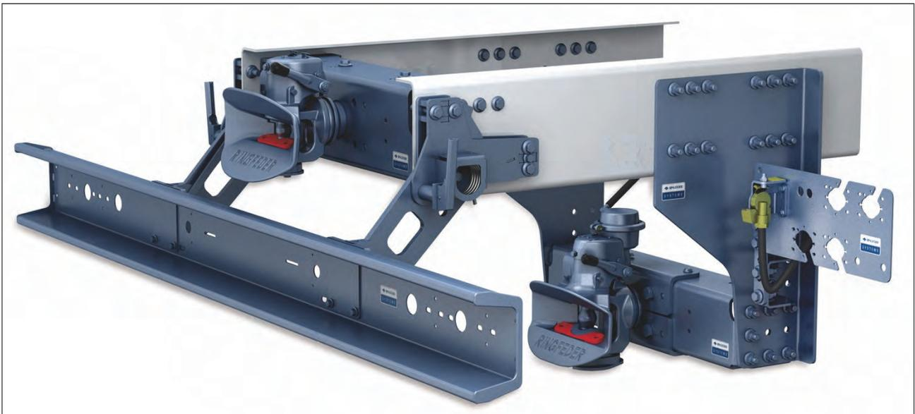
**Bemerkung:** Nachträglicher Einbau eines Ringfeder Tiefkuppelsystems
