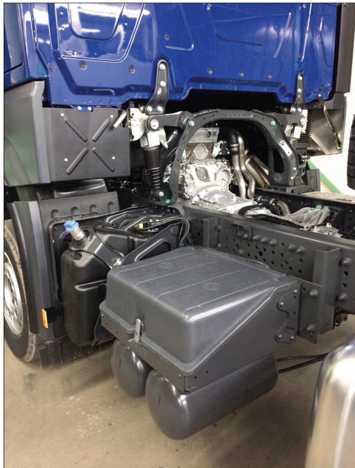
**Bemerkung:** Batterieträger inkl. darunterliegende Luftkessel nach unten versetzen.
