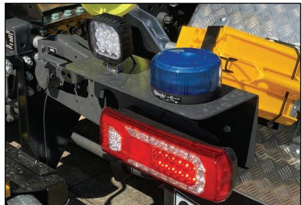
**Bemerkung:** Nachträglicher Einbau Zusatzbeleuchtungen und Feuerwehrtechnik.
