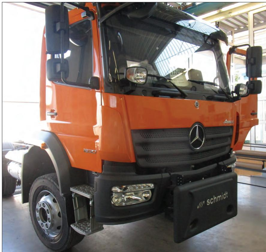
**Bemerkung:** Fahrzeugseitige Geräteanbauplatte nach DIN EN 15432-1, Typ F1/C (ehemals DIN 76060, Form A bzw. Größe 5). 2 frontseitig montierte Zusatzscheinwerfer mit Abblendlicht, Fernlicht und Blinkleuchten für den Schneeflugbetrieb („Winterdienst-Beleuchtung“) / Steckdose (24V; 3-polig/7-polig) für die Pflugbegrenzungsleuchten.
