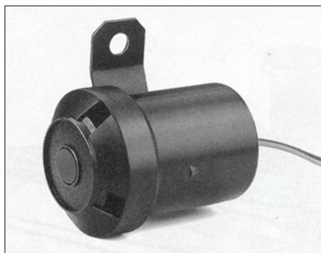
**Bemerkung:** Nachträglicher Einbau eines akustischen Rückfahrsummers. Beim Einlegen des Rückwärtsganges wird die akustische Rückfahrwarneinrichtung aktiviert. Durch Betätigen eines Tasters in der Instrumententafel kann der Summer abgeschaltet, bzw. quittiert werden.
