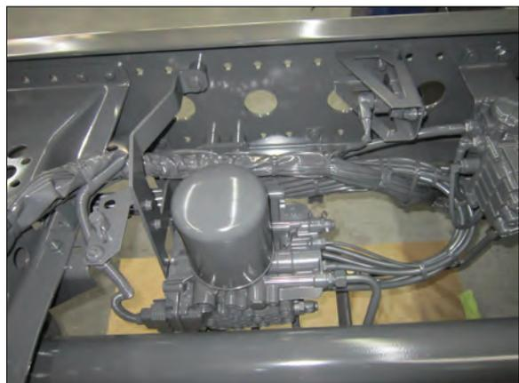
**Bemerkung:** EAPU in den Rahmen versetzen für Freiraum am Rahmen
