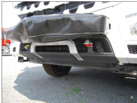
**Bemerkung:** Fertigung und Montage eines Querträgers vorne mit Rangierkupplung inkl. Lieferung und Montage eines zweiten Abschleppschäkels zur Montage des Querträgers, Lackierung in Novagrau, Bolzendurchmesser 34 mm, Anhängelast 18 t.
