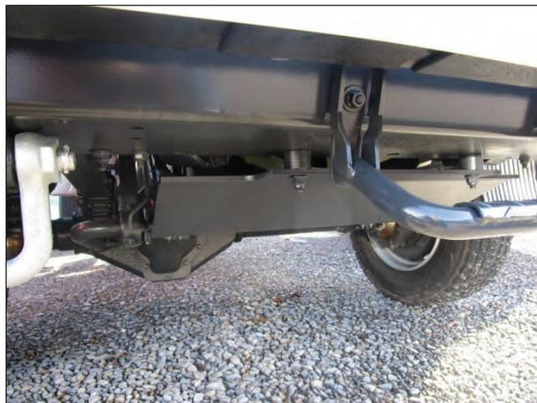
**Bemerkung:** Nachträglicher Einbau einer Schutzplatte verstärkt aus Stahl für Motor und Kühler für z.B. anspruchsvolle Off-Road Einsätze
