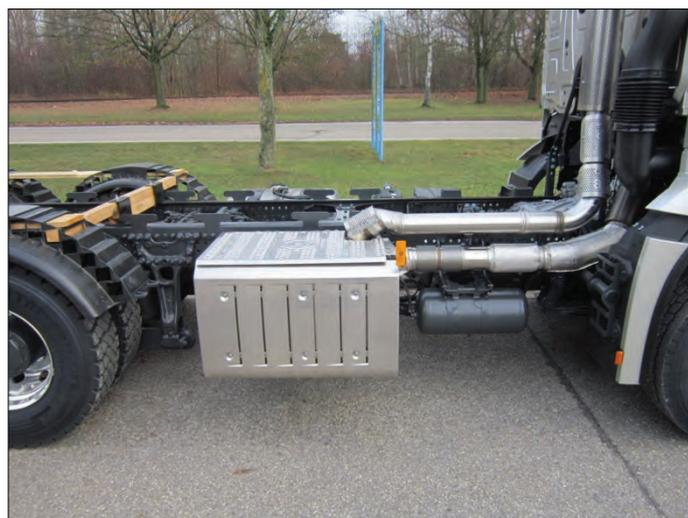
**Bemerkung:** Modifikationen der Abgasanlage im Rahmen der ABH Richtlinien und nach Rücksprache mit dem Aufbauhersteller
