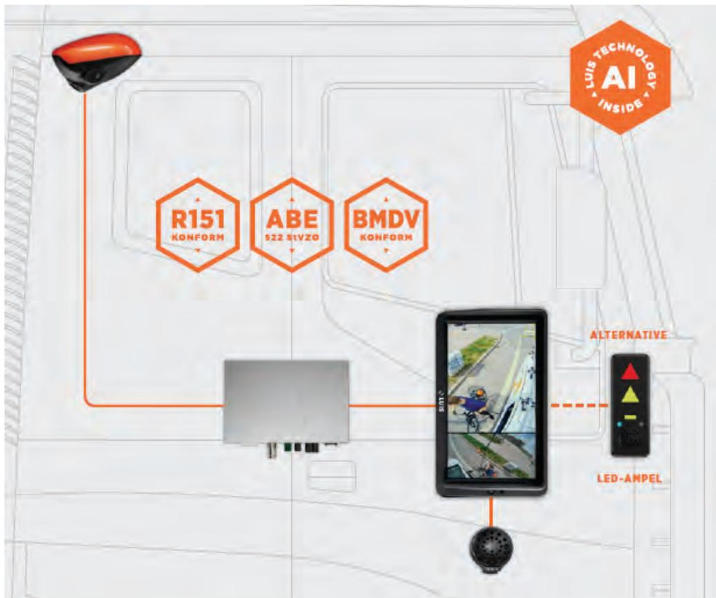
**Bemerkung:** Förderfähiges Abbiegeassistentensystem mit ABE, Kamerabasiert, 7" Monitor idR an A-Säule rechts montiert, Sehr großer Anwendungsbereich vom Kommunal-Feuerwehrebereich, aber auch Sattelzugmaschine, Möglichkeit zur Kombination mit Rückfahrkamera auf einen Bildschirm geschaltet.
