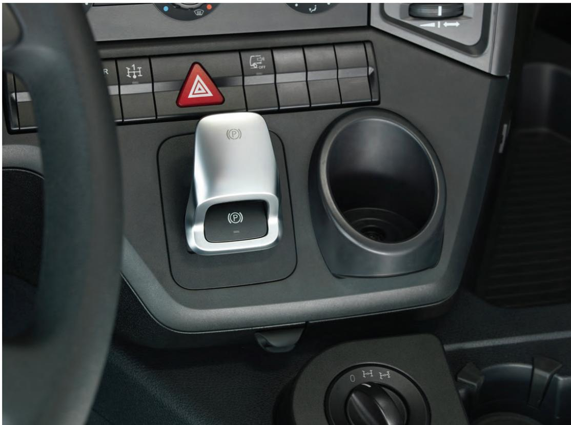
**Bemerkung:** Durch den Einbau einer zusätzlichen pneumatischen Steuerung oder zusätzlicher Federspeicherbremszylinder (je nach Variante) wirkt die Feststellbremse auf alle Räder
