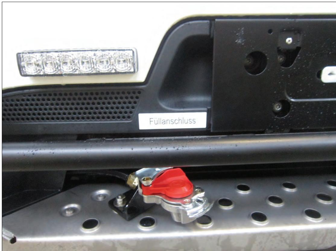
**Bemerkung:** Kupplungskopf vorn zum Luftnachfüllen im Bereich Stoßfänger links montiert oder nach Absprache ähnlich Code B5N oder B5P
