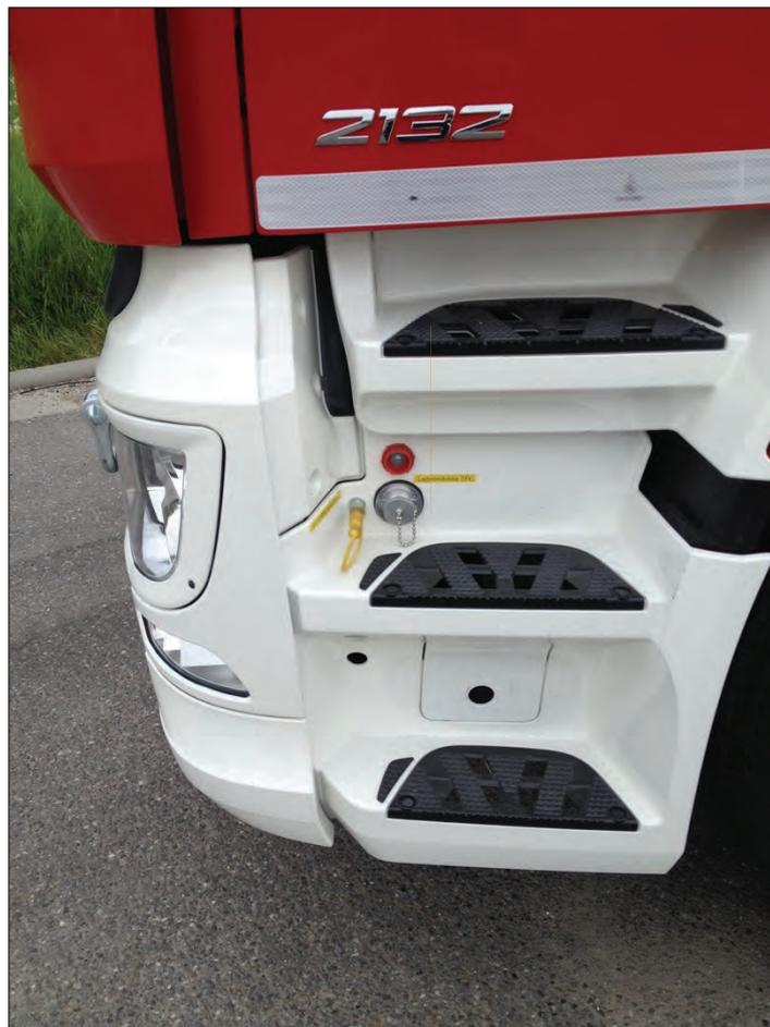
**Bemerkung:** Nachträglicher Einbau Druckluftfremdeinspeisung nach Absprache oder z.B. im Einstieg links.
