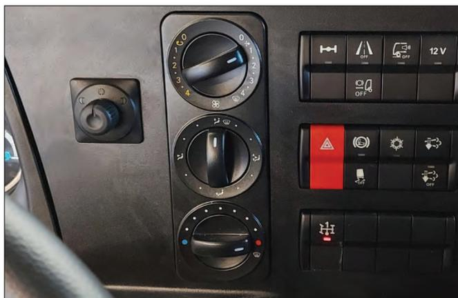
**Bemerkung:** Nachträglicher Einbau eines beheizten verstellbaren Rampenspiegels.
