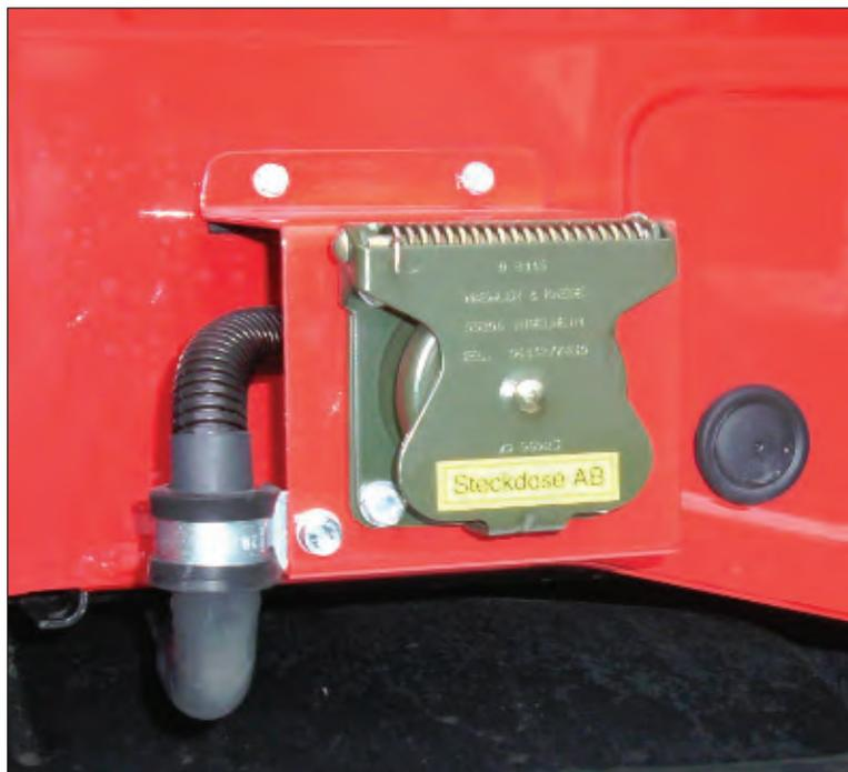
**Bemerkung:** Nachträglicher Einbau einer 24 V Steckdose für Wechselladerfahrgerüste montiert an Fahrerhausrückwand mit Belegung nach DIN oder individuellen Kundenangaben
