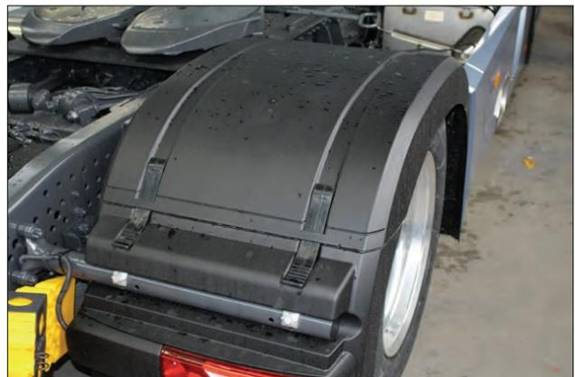
**Bemerkung:** Nachträglicher Einbau von Halter für Kotflügeloberschalen
