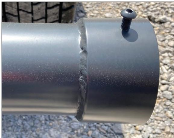
**Bemerkung:** Nachträglicher Einbau Anschlusses am Abgasendrohr zum Anschluss an eine Abgas Absauganlage
