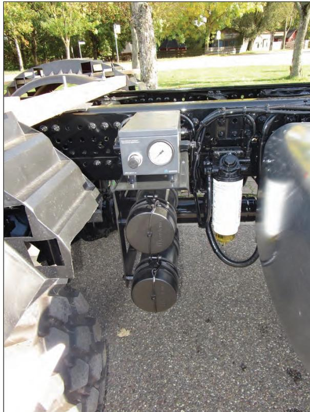
**Bemerkung:** Reifenfüllsystem (SEMI) mit Zentraldruckregler und Regelanschluss für jedes Rad sowie Zubehör und Schlauchdepots.
