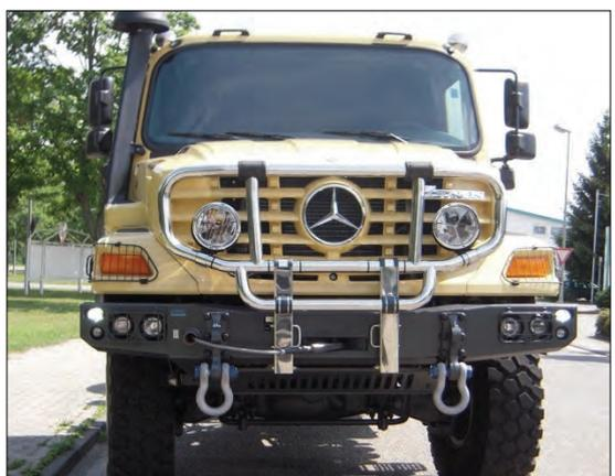
**Bemerkung:** Nachträglicher Einbau von je 2 Schäkel vorne und hinten, 65 kN, Schrägzug 0°, geschweifte Form nach DIN
