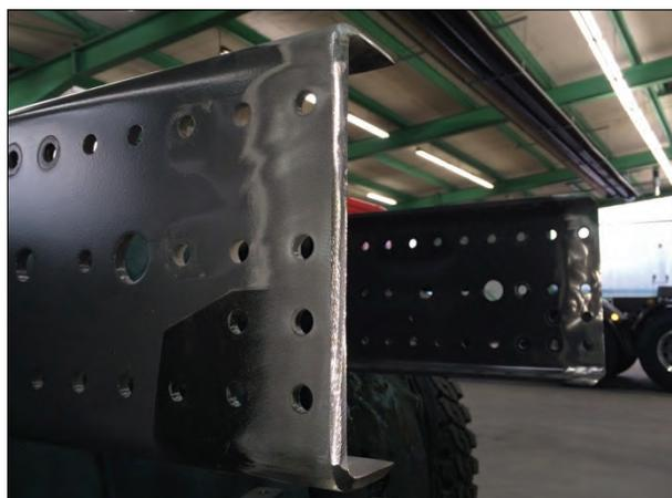
**Bemerkung:** Die Rahmenüberhangsänderung erfolgt unter Berücksichtigung der Aufbauherstellerrichtlinien. Bei der Verlängerung des Rahmenüberhangs wird ein zertifiziertes Schweißverfahren angewendet
