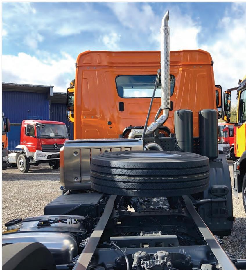
**Bemerkung:** Fahrgestellanpassung für Kehrmaschinenaufbau unter Berücksichtigung der Fahrzeug- und Aufbauspezifikation und der jeweils gültigen ABH Richtlinien.
