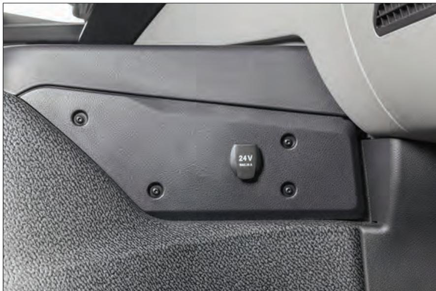
**Bemerkung:** Nachträglicher Einbau einer 24 V Steckdose in der Instrumententafel.
