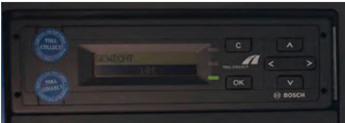
**Bemerkung:** Einbau einer OBU zur Mauterfassung mit Tachoprüfung
