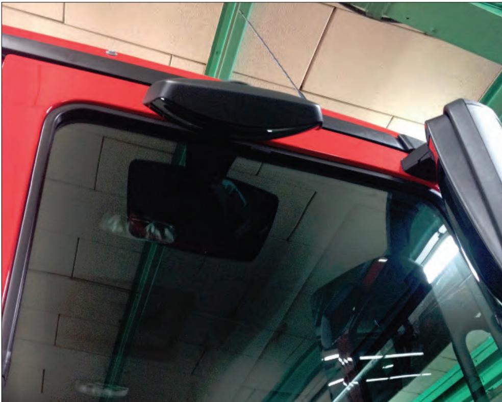
**Bemerkung:** Nachträglicher Einbau eines beheizten Rampenspiegels.
