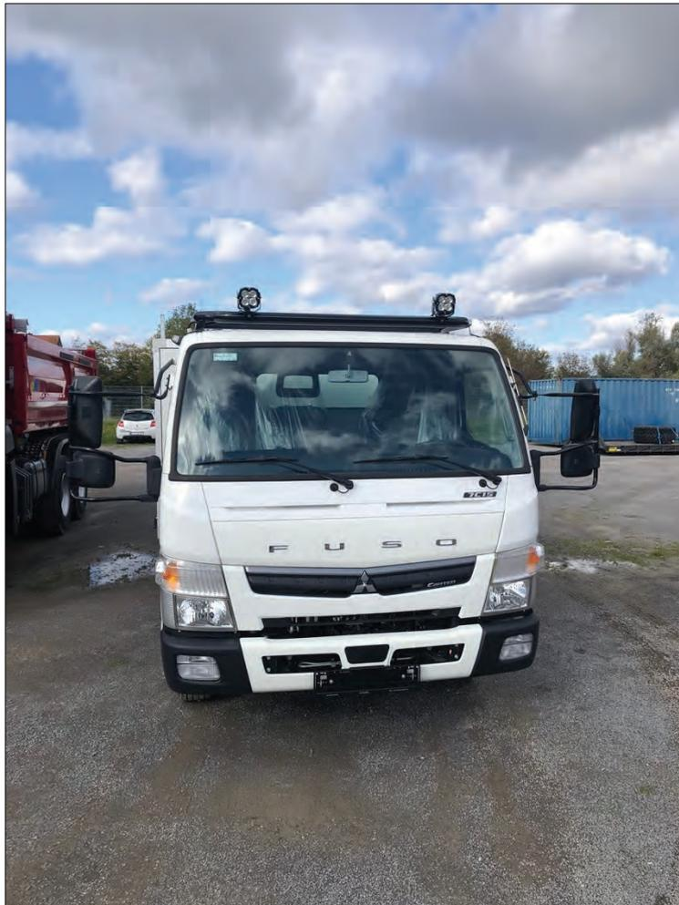
**Bemerkung:** Einbau eines Dachlampenbügels auf dem Fahrerhaus, Dachlampenbügel aus Edelstahl, inkl. elektrischer Vorbereitung mit 8-poligem Fahrerhauskabel, Kit Montageschelle Scheinwerfer Montageplatte für Rundumleuchte. Auf Wunsch schwarz Lackiert.
