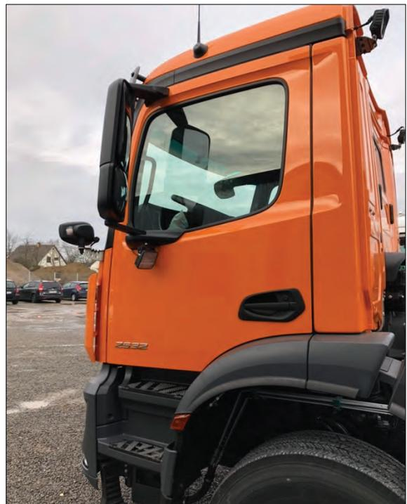
**Bemerkung:** Nachträglicher Einbau Manövrier- und Sicherheits-Scheinwerfer in LED zur Ausleuchtung des rückwärtigen Arbeitsfeldes. Bedienschalter und Kontrollleuchte in der Instrumententafel. Scheinwerfermontage im Bereich Spiegelarm
