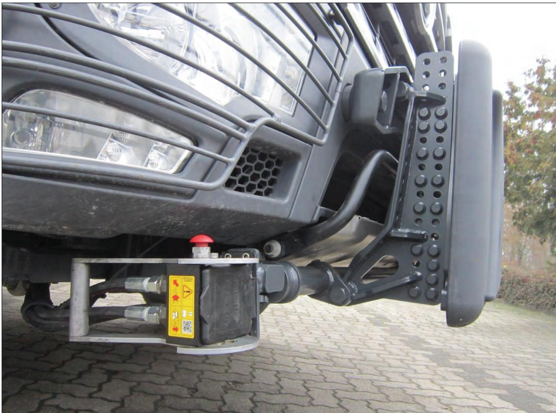
**Bemerkung:** Alternativ zu Konventionellen Hydraulikkupplungen um schnellen an und abkuppeln der Hydraulikaggregate
