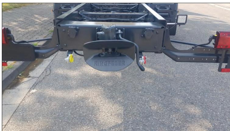
**Bemerkung:** Nachträglicher Einbau einer Anhängerkupplung.
