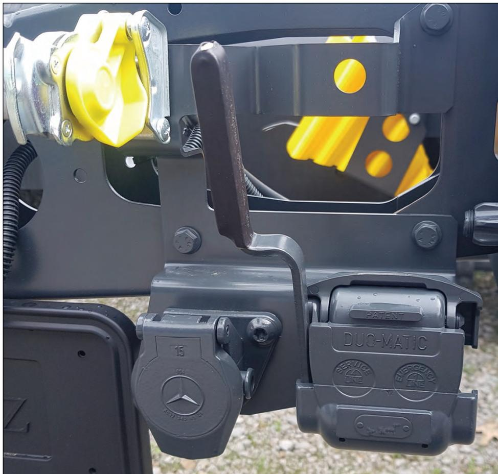
**Bemerkung:** Duo-Matic Schnellkupplungen für einfache und schnelle Druckluftversorgung, Vorrat und Bremse
