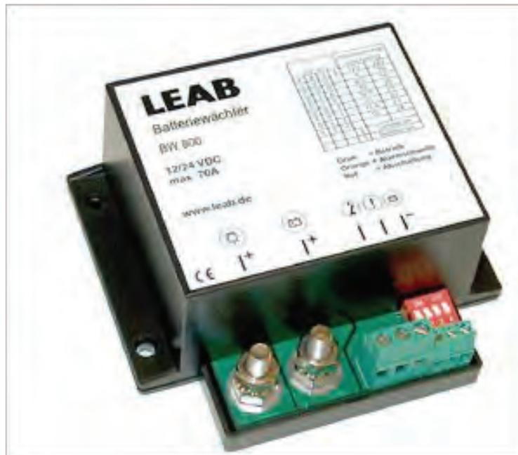
**Bemerkung:** Nachträglicher Einbau eines Unterspannungsschutzschalters Typ LEAB Batterywatch 800.
