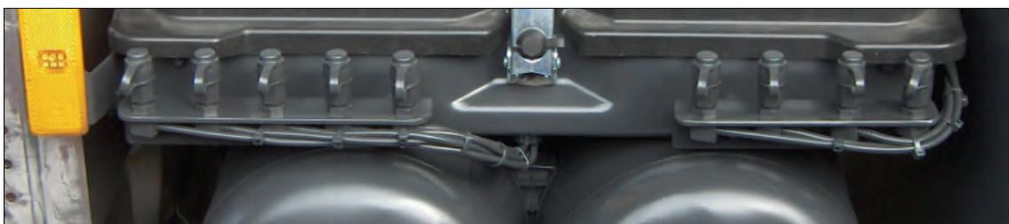
**Bemerkung:** Nachträglicher Einbau Prüfanschlüsse an zentraler Stelle für schnelleren Zugriff bei z.B. SP Prüfung.
