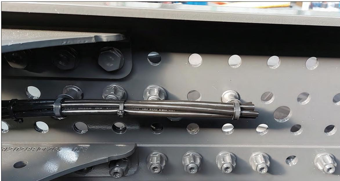
**Bemerkung:** Entlüftungsleitungen zentral und nach oben verlegt für Wasserdurchfahrtsfähigkeit von ca. 800 mm.
