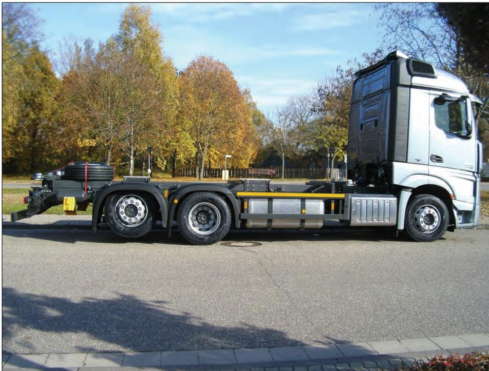
**Bemerkung:** Nachträglicher Einbau BDF Wechselrahmen
