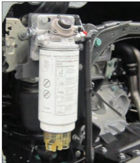
**Bemerkung:** Nachträglicher Einbau Kraftstofffilter Wasserabscheider
